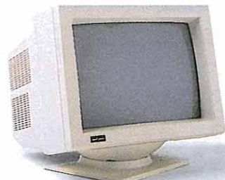
Monitor color RGB de 16 colores, cristal oscuro y pantalla de 14", totalmente compatible.
